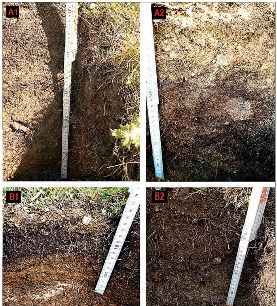
Abb. 5: In allen Profilen ist zu beobachten, dass die Wurzeln der Vegetation auf den Ziegeln vital und in den Ziegel-Untergrund eingewachsen sind.
